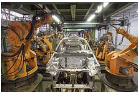
Figura 1.7. KUKA IR 160/60 Roboți instalați în 1983 [2]
