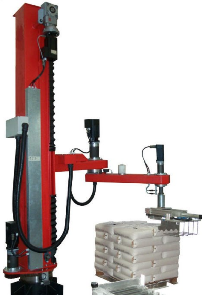
Figura 1.5. Robot Scara utilizat la paletizare [3]
