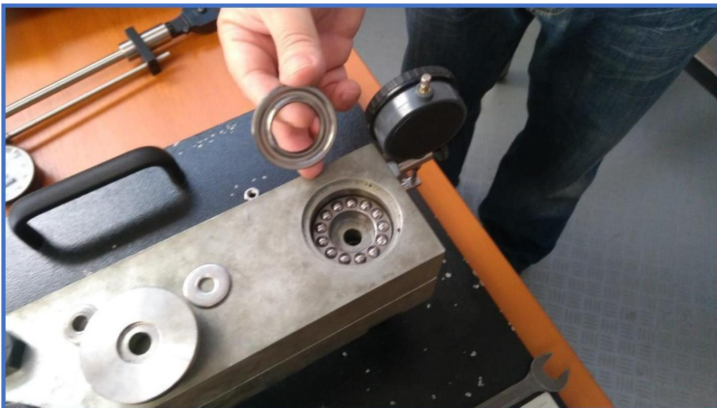
Figura 10 - Standul de măsurare în configurația din Figura 3 (b) – Rulmentul axial
