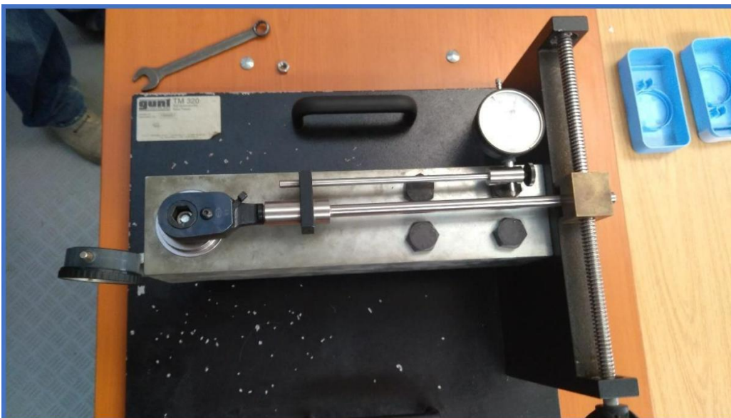
Figura 7 - Fixarea cheii dinamometrice în piulita șurubului de acționare
