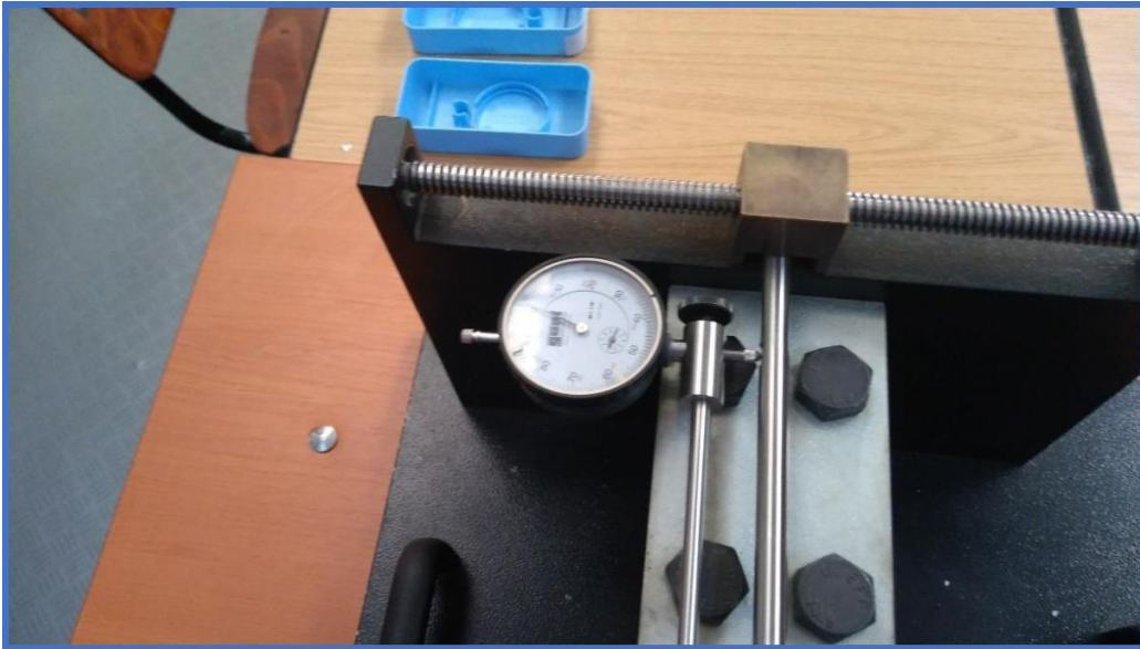
Figura 8 - Fixarea cheii dinamometrice, aducerea la ZERO a comparatorului
