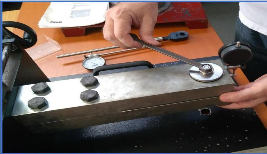
Figura 12 - Strângerea inițială a șurubului
