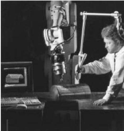
Figura 2. Suprafața piesei este digitizată și modelul este utilizat pentru generarea automată a traiectoriei sculei
